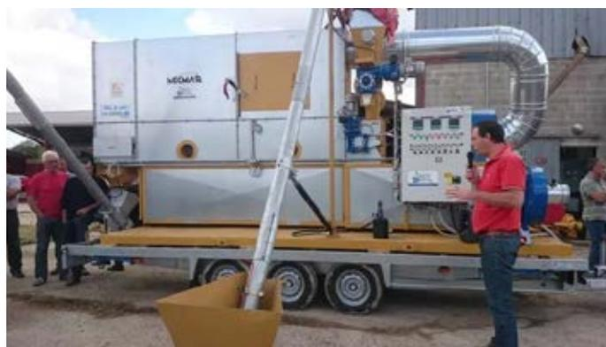
Une fois chauffée à cœur, la graine se dirige hors de la chambre de torrification pour être ensuite déposée le plus souvent dans une remorque.
