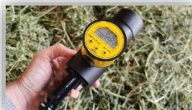
Cet outil, transportable facilement permet de ne pas déplacer d'outils si le fourrage n'est pas suffisamment sec. Il permet de donner le taux d'humidité du fourrage en dessous de 50% (utilisable pour de l'enrubannage ou du foin mais pas pour de l'ensilage).
